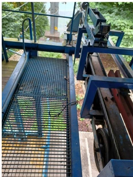
۱۸- ارائه مستندات طراحی سیستم Tension شامل تناژ وزنه و قطر سیم بکسل‌های وزنه و مشخصات قرقره‌های نگهدارنده وزنه الزامی است. تعبیه سیستم روشنایی و وسیله دسترسی مناسب به چاه و وزنه کشش با در نظر داشتن شرایط حرکت وزنه و فضای حرکتی آن به منظور تامین ایمنی پرسنل الزامی است (بند ۱۳ از استاندارد ۱۱۳۵۳). همچنین اجرای سطح مناسب بر روی وزنه کشش به منظور فراهم نمودن شرایط بازرسی ایمن برای کارکنان الزامی است.
