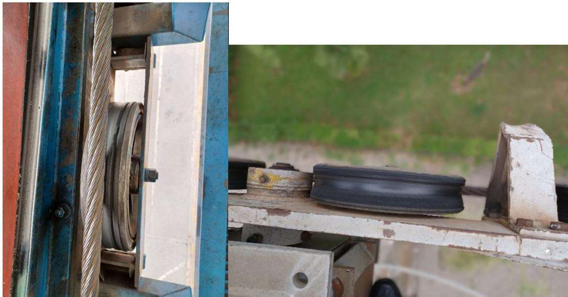
۹- وجود آثار زنگ زدگی و خوردگی در بین‌های قرقره‌ها و رولر باتری‌ها که پس از دمونتاز و زنگ زدایی و انجام تست‌های غیر مخرب در صورت نیاز باید طبق متریکال اصلی سازنده جایگزین گردد (الزامات استاندارد ۱۱۳۵۸).
