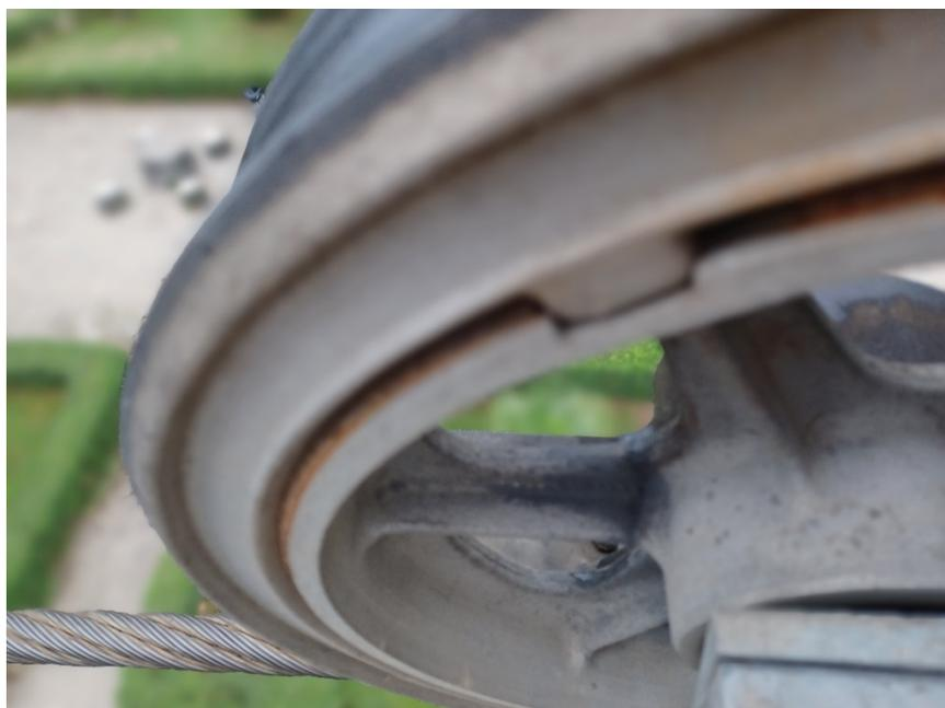
۱۱- عدم وجود کاور قرقره‌ها که لازم است بهره بردار محترم نسبت به تعبیه و مونتاژ اصولی در این خصوص اقدام نماید.
