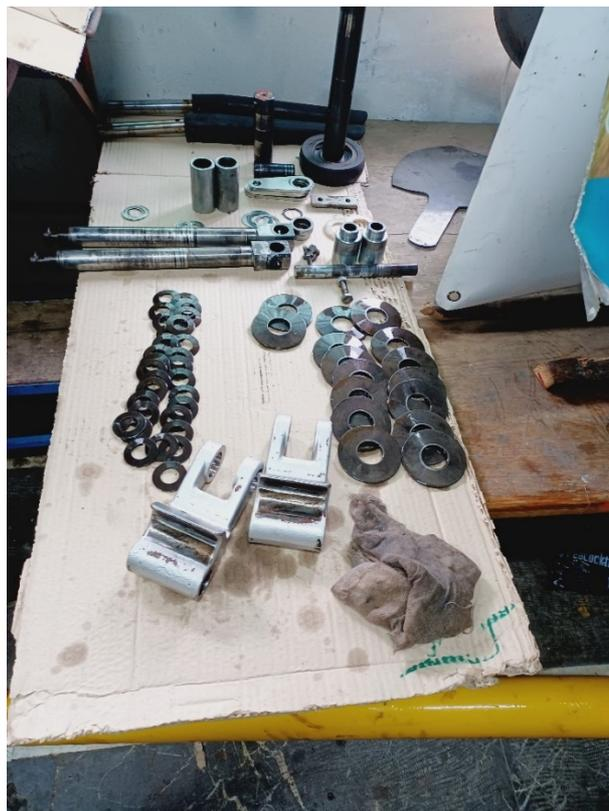
۳۳- با توجه به الزام بند ۶-۳-۵-۷ استاندارد ملی ۹۴۲۰، حداقل ۱۰ درصد از قفل‌ها (Gripper) بایستی مورد تست لغزش (Pull-test) قرار گیرند، این کار بایستی با استفاده از ادوات ارائه شده توسط سازنده و یا مشابه آن بر روی کابل انجام گردد فلذا آزمون مورد بحث پس از فراهم شدن تجهیزات مورد نیاز تست انجام خواهد شد. همچنین بایستی حداقل ۲۰ درصد از قفل‌ها به طور کامل دمونتاژ شوند تا در دور بعد بازرسی مورد بازرسی چشمی قرار گیرند که پس از فراهم نمودن شرایط انجام خواهد شد.
